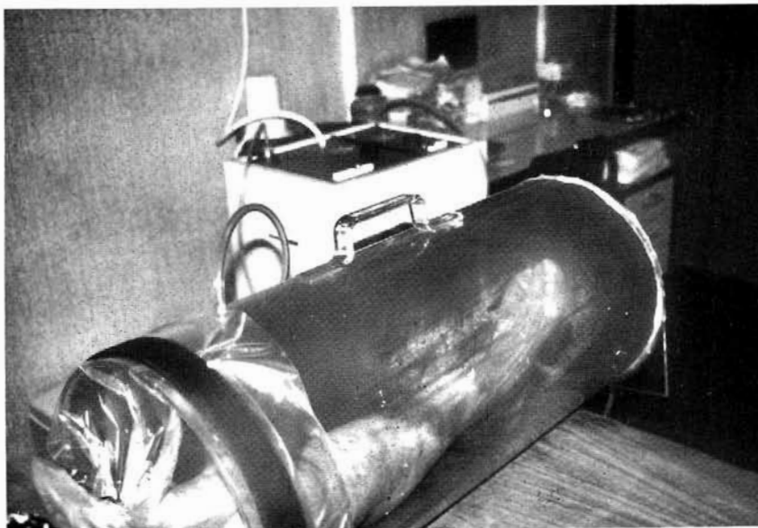
Fig. 5 - Cilindro de vacío para el tratamiento tópico con Ozono de úlceras de las piernas.
