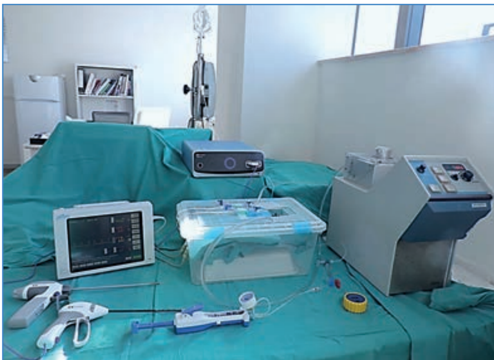
Figura 1. Circuito de flujo pulsátil utilizado para el estudio y el registro de la presión con monitor y manómetro. En la esquina inferior izquierda se visualizan los dos dispositivos de sellado por energía.
